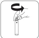
Ouvrez la cuvette de réactif (Reagent A).
