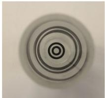
2. Remplir le tube petit à petit avec l'effluent jusqu'à ce que les cercles noirs au fond du tube ne soient plus visibles.
