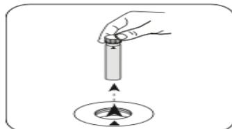
Retirez la **cuvette** de la chambre de mesure.
