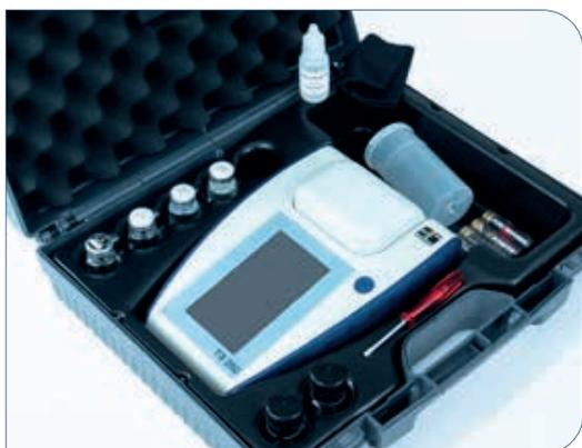
Portable dans une mallette ou à un poste de travail fixe : le turbidimètre TB350 est idéal pour une utilisation mobile sur le terrain, par exemple pour la surveillance des systèmes de distribution d'eau, et pour les laboratoires qui analysent un grand nombre d'échantillons.
