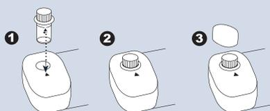
**Tenez** les cuves par le bouchon afin d'éviter les salissures et les empreintes digitales sur le verre. Enlevez les impuretés avec un chiffon non pelucheux. Indexez la cuve pour une précision de mesure maximale.
