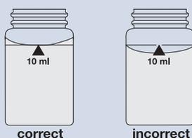
**Remplissez** l'eau de l'échantillon jusqu'au repère sur la cuve. La plupart du temps, l'eau ne remplit pas la cuve avec une surface plane, mais avec une surface d'eau bombée. Le point le plus bas de l'échantillon d'eau doit se trouver à la hauteur du repère.
