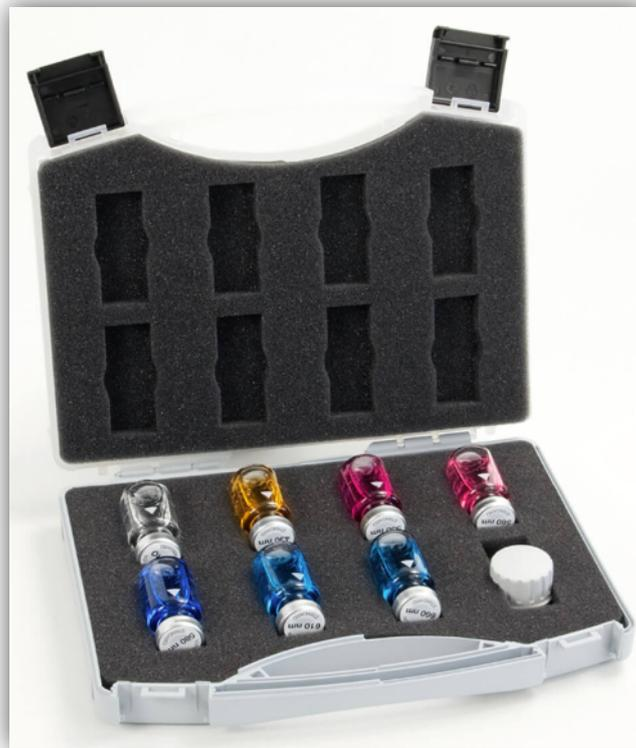
Les étalons de contrôle du MD 100 / MD 200 servent à vérifier l'exactitude de la détermination et la reproductibilité des résultats, basées sur les longueurs d'onde intégrées.
